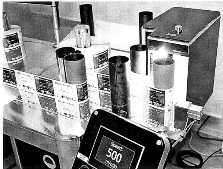
毎分 500m の超高速で搬送するラベルの全数検査も可能
